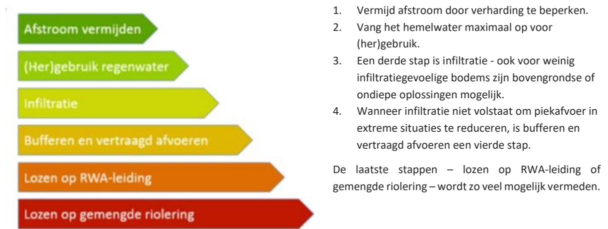
Figuur 15: Ladder van Lansink - toepassen van maatregelen over verwerking hemelwater. Bron: Leidraad ontwerpen van bronmaatregelen – Integraal waterbeleid
