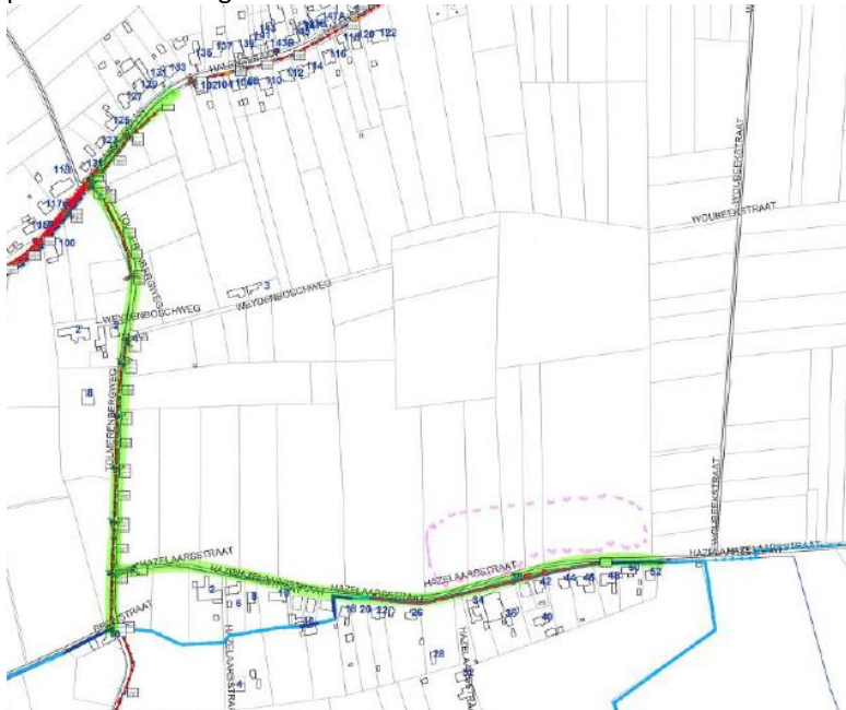
Figuur 101: Conceptschets van het rioleringsproject “Tieltsestraat & Hazelaarsstraat” (Fluvius, R2661), waarbij er ook een zone is aangeduid voor erosie maatregelen (roze stippellijn).
