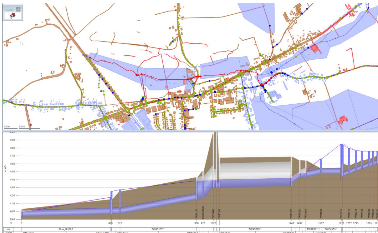
Figuur 88: Lengteprofiel van de Manhofloop (niet-gecategoriseerd) en de Wingebeek (waterloop 2 de categorie) van de simulatie van het model bestaande toestand van het zuiveringsgebied van Sint-Joris-Winge voor een T20-bui in de software ICM.
