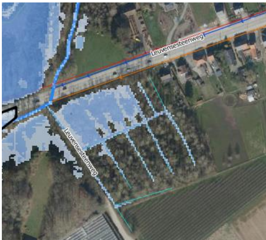
Figuur 112: Luchtfoto van de omgeving van de kruising van de Leuvensesteenweg met de Winge. Daarnaast wordt ook de VHA (Vlaamse Hydrografische Atlas), het rioleringsstelsel en de pluviale overstromingskaart (huidige toestand – grote kans) weergegeven. (Bronnen: waterinfo.be & geopunt.be)
